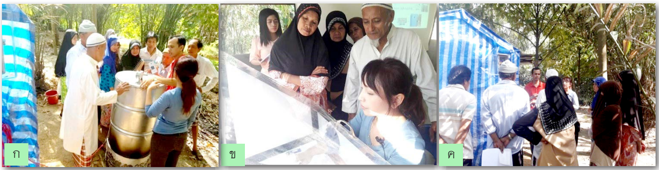
ภาพที่ 6 การพัฒนาและการถ่ายทอดเทคโนโลยีวิศวกรรมของระบบผลิตเชื้อราบิวเวอเรีย ก) หม้อนึ่งฆ่าเชื้อ ข) ตู้แช่เชื้อ และ ค) โรงบ่มเชื้อระบบควบคุมอัตโนมัติ
