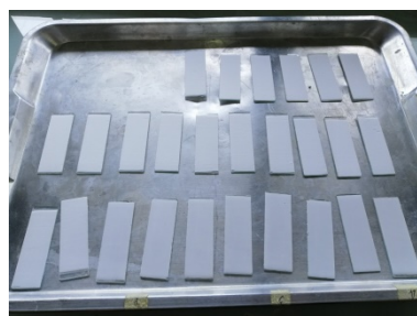
ภาพผนวกที่ ค3 การเตรียมอุปกรณ์สำหรับ thin layer chromatography (A) การเตรียมแผ่น TLC และ (B) การชะด้วยตัวทำละลาย
