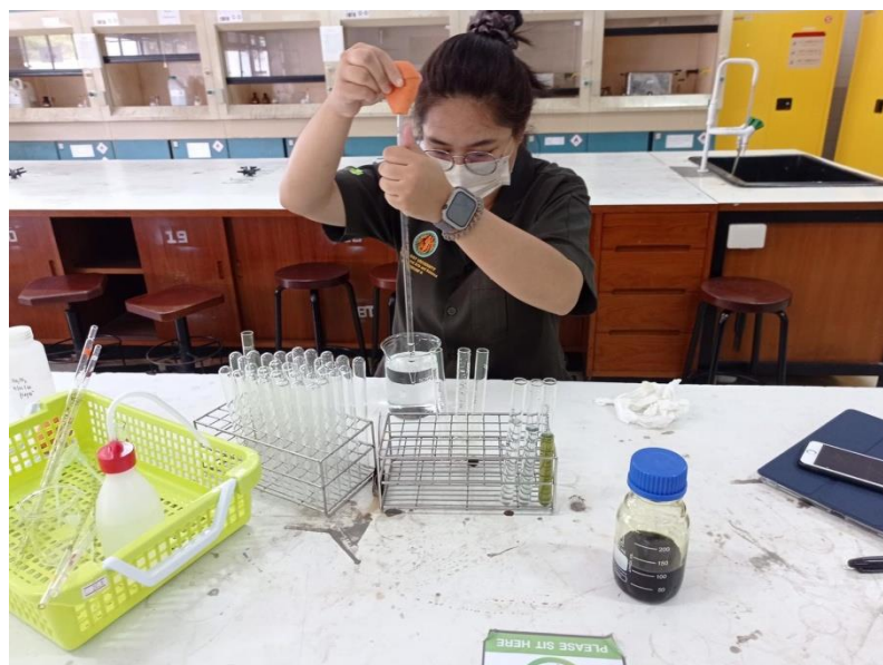
ภาพที่ 5 เตรียมสารละลายสำหรับการทดสอบปริมาณฟีนอลิกโดยรวมด้วยวิธี Folin-Ciocalteu
