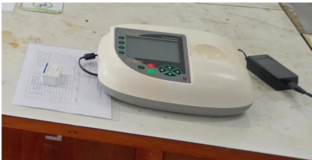
ภาพที่ 6 เครื่อง spectrophotometer สำหรับวัดค่าการดูดกลืนแสง
