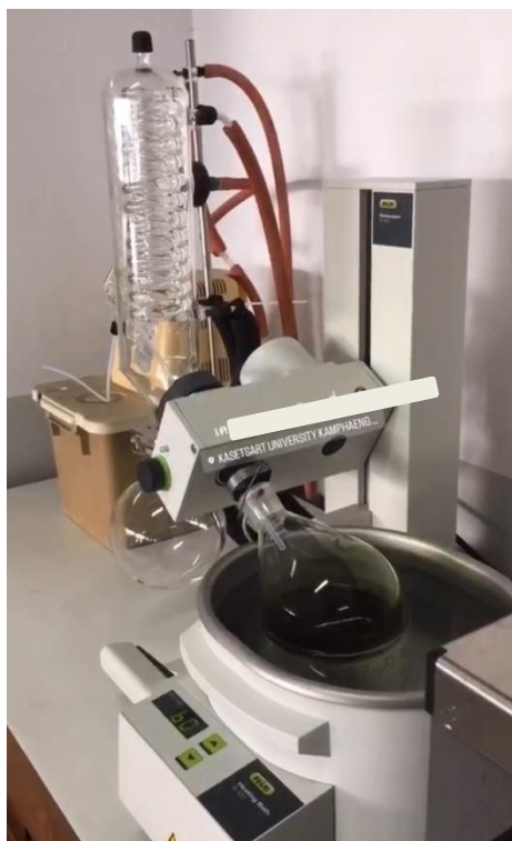
ภาพที่ 2 นำสารสกัดใบเตยไปกลั่นแยกตัวทำละลายด้วยเครื่อง Rotary evaporator
