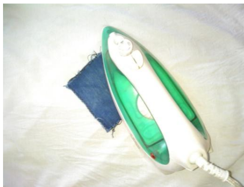
รูปที่ 4 การทดสอบผ้าฝ้ายทดลองด้วยน้ำยารีดผ้าเรียบและความร้อน
