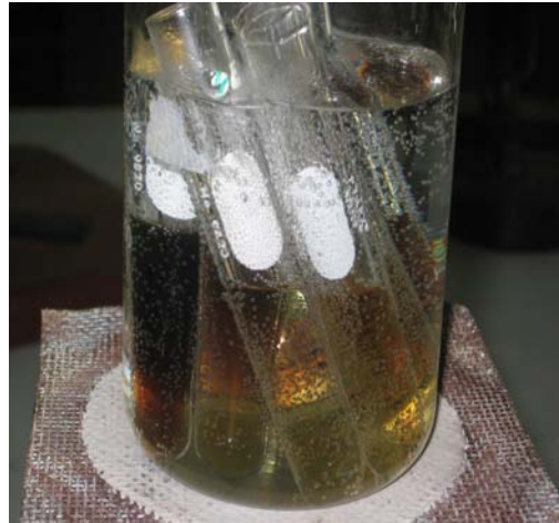
ภาพที่ 6 การเปลี่ยนแปลงสีของสารละลายทั้ง 6 หลอด ในขณะที่ต้ม
