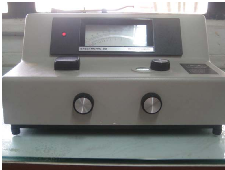
ภาพผนวกที่ 2 เครื่อง Spectrophotometer (MILTON ROY รุ่น Spectronic 20)
